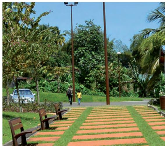
Exemple de dispositif alternatif de gestion d'eaux pluviales : parking végétalisé, bourg de Sainte-Luce
