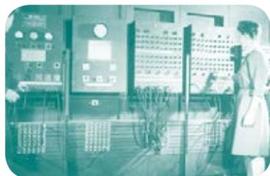
**1944** \_ Construit par **IBM**, le **Harvard Mark 1** est une calculatrice à relais, de la taille d'une pièce. Son principal défaut : il ne pouvait stocker que très peu de programmes électroniques...
