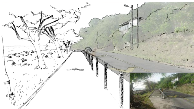
▲ Rénovation de l'alignement élargissement de la piste cyclable, mise en place d'une protection de bois
